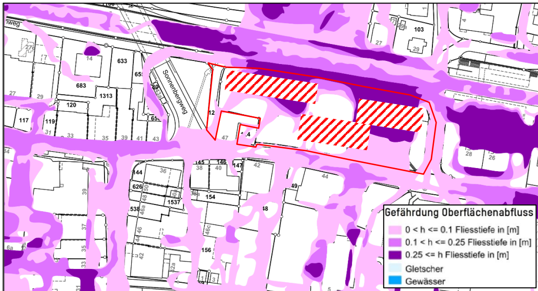
Abbildung 2: Gefährdungskarte Oberflächenabfluss. Gebäude QP Zentrum Itingen (rot schraffiert) und betroffene Parzellen (rot umrandet).
